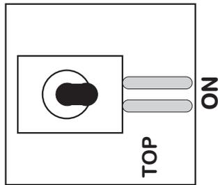
INSERT JUMPER ONLY IF NOT USING AUX JACK CABLE.
